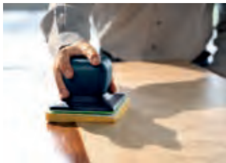
Ytbearbetning med oljeapplikatorn SURFIX.
