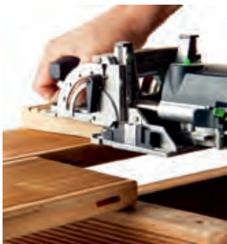
Trädäckförbindningar utan synliga skruvar
