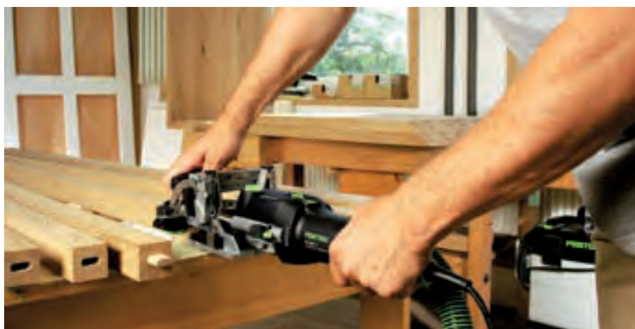
Bra tillbehör underlättar arbetet: Med listanslaget riktar man in smala trälistor utan problem, även för geringsfräsning.
