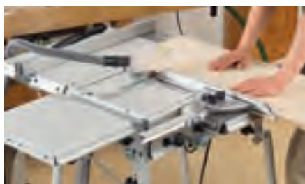
Variabla och exakta snitt tack vare inställning av såghöjd och sågklingans vinkel.
