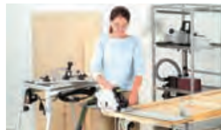
Med sänksågarna växlar man snabbt mellan att arbeta stationärt eller på styrskenan, vilket ger dem en dubbel fördel.
