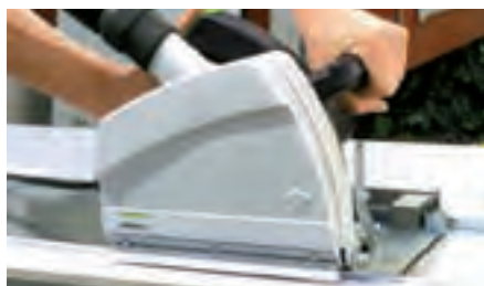
Optimerat dammsug tack vare sluten utsugskåpa och tätningsborste.
