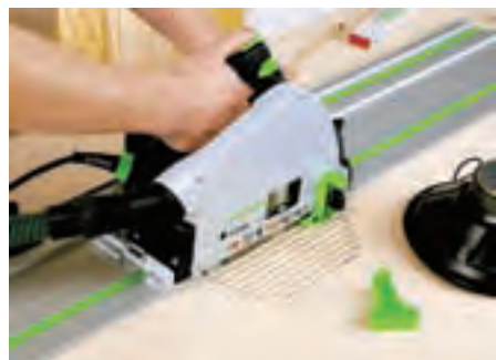
Splitterfri sågning på båda sidor, tack vare styrskena och monterbart splitterskydd.
