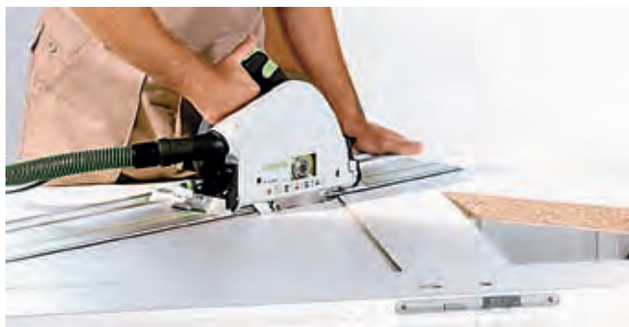
Praktisk för utskärningar: Med en sänksåg från Festool och styrskenan sågar man säkert och exakt – även vid komplicerade geometriska former.
